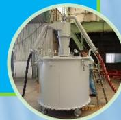
MバキュームFLはダイオキシンや重金属などの有害物質を含む回収物も作業場所周辺へ飛散させることなく密閉状態のままフレコンバッグへ集積することができる周辺環境と作業効率の向上を実現したバキューム装置です。
